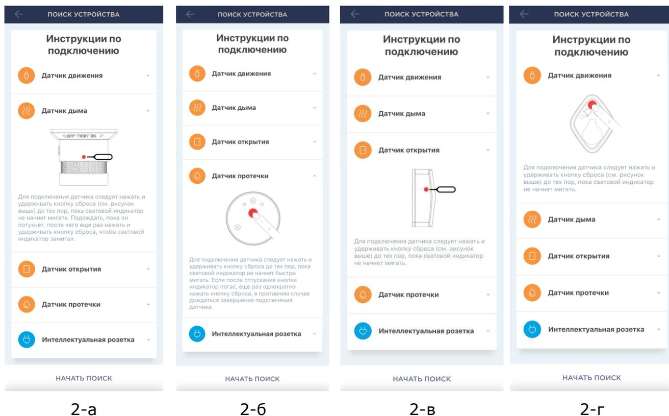
**Рисунок 2 – Расположение кнопок сброса на датчиках**
