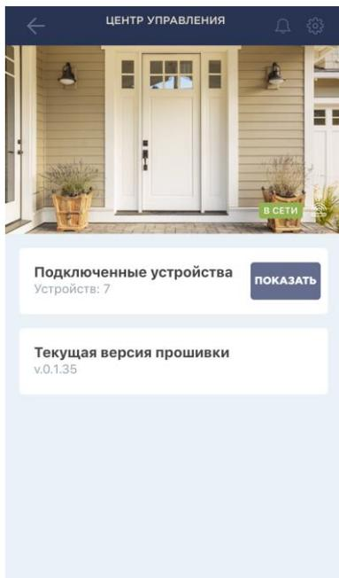
Для центра управления предусмотрена одна вкладка в панели управления, где можно посмотреть данные по количеству подключенных к нему устройств, а также текущую версию прошивки.
