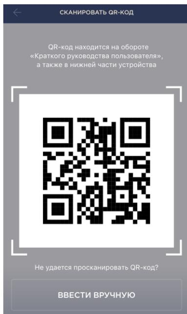
**д.** найти наклейку с QR-кодом на обороте краткого руководства пользователя (идет в комплекте с центром управления) либо в нижней части устройства и расположить смартфон на расстоянии 15-20 см от него таким образом, чтобы QR-код полностью попадал в рамку на экране смартфона (см. рисунок слева).
