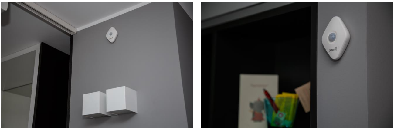
Рисунок 5 – Варианты установки датчика движения
