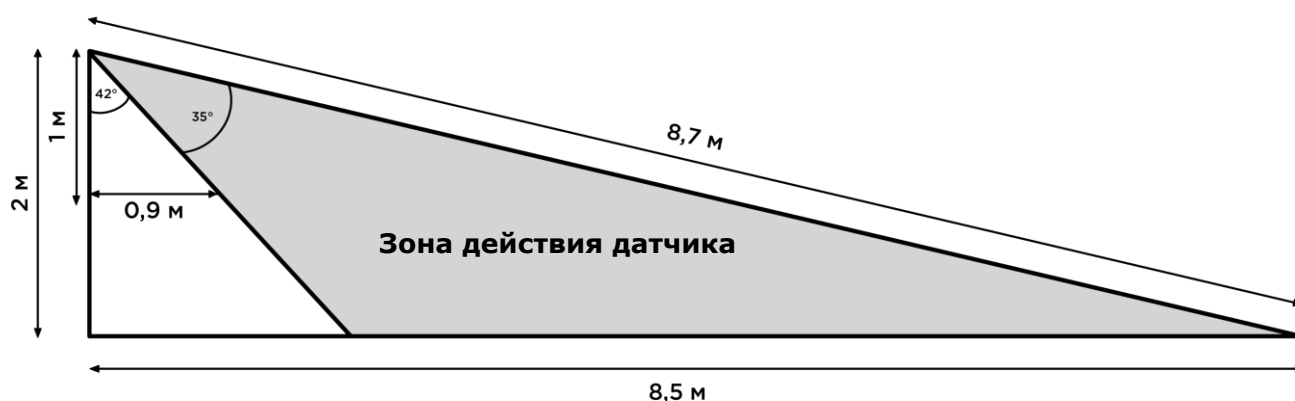
3-в – Детализация угла обзора по вертикали
